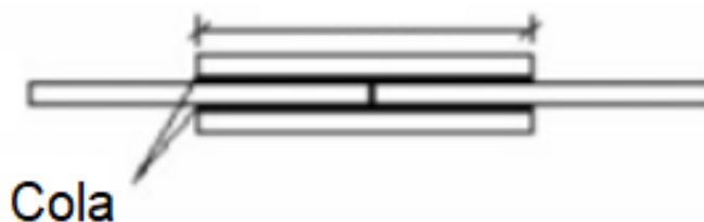
Figura 1 – Esquema de emenda das barras
