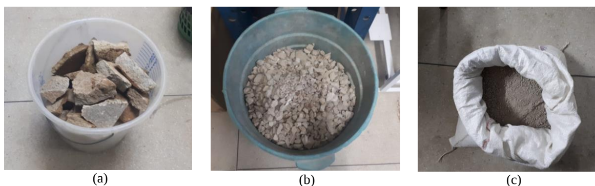
Figura 2 – Processo de trituração do resíduo: a) Resíduo coletado; b) Resíduo triturado; c) Resíduo triturado e peneirado.
